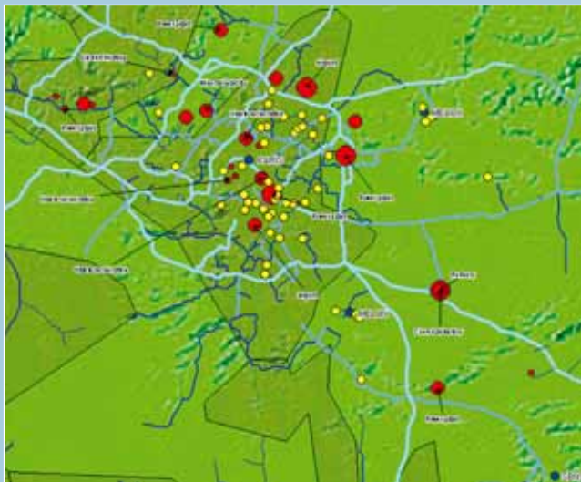
◀ Le réservoir aquifère du Dogger offre une capacité de stockage de plus de 4 milliards de tonnes de CO 2 . En rouge figurent les principales zones industrielles émettrices de CO 2 .
