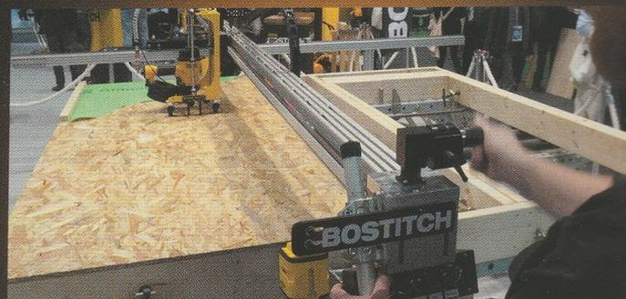
Avec une simple alimentation pneumatique, vous pourrez clouer votre contreventement et poser vos tasseaux d'un simple coup de manivelle sans monter sur le panneau. S'adapte à tous types de table.
